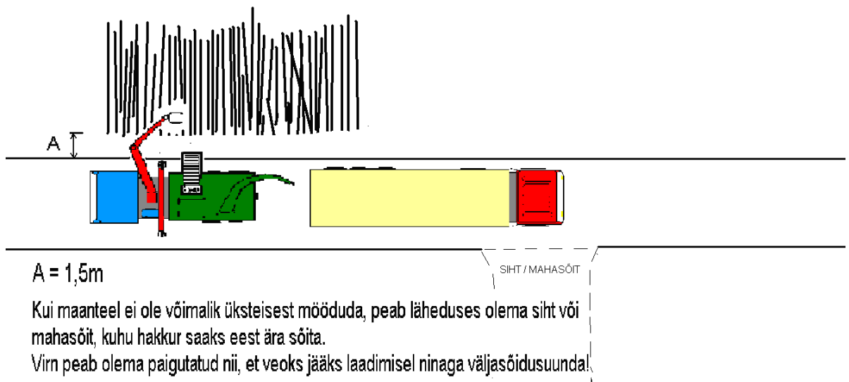
Joonis 1. Hakkimine, kui hakkur asub konteinerveoki taga
